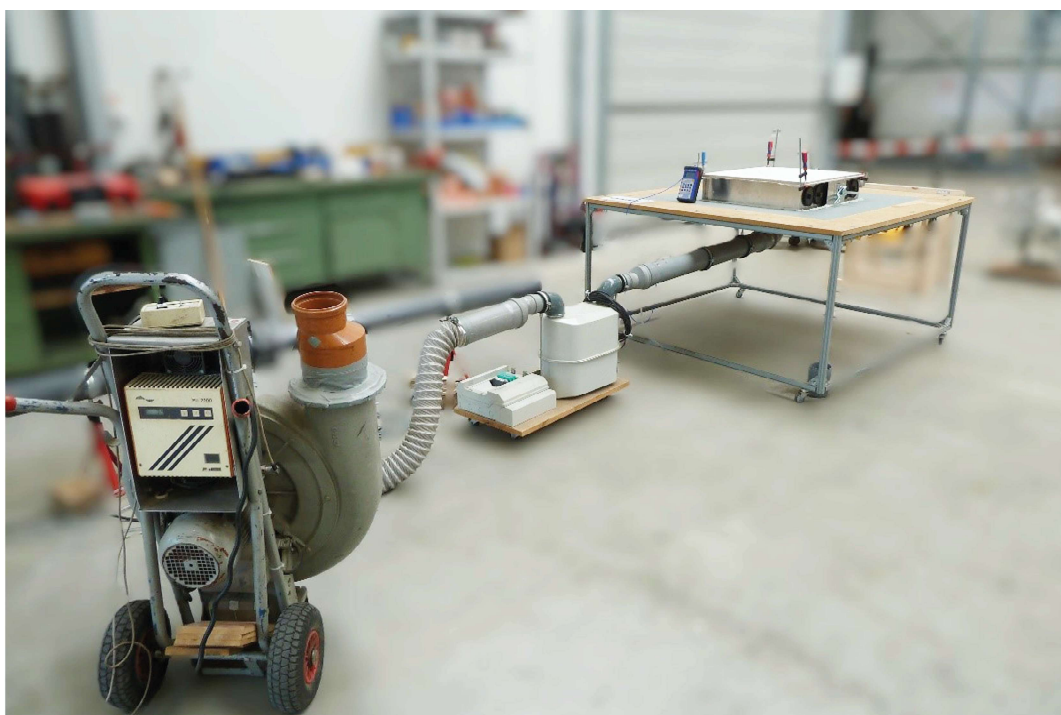
Abbildung 2: Prüfaufbau zur Messung der Gehäuseleckage
