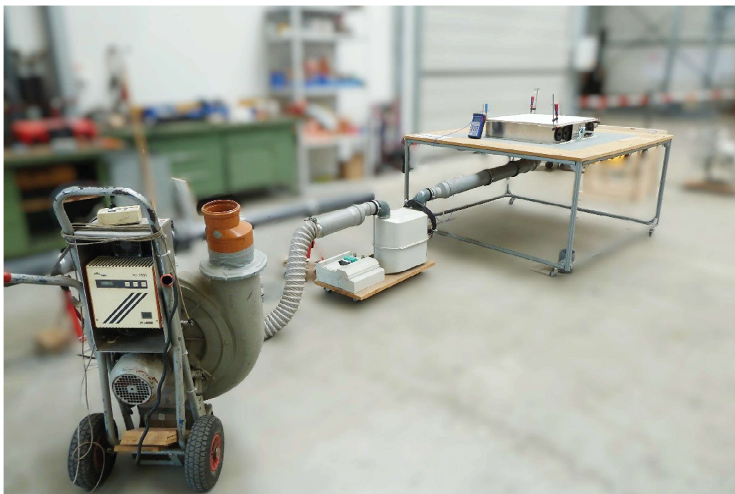
Abbildung 2: Prüfaufbau zur Messung der Gehäuseleckage
